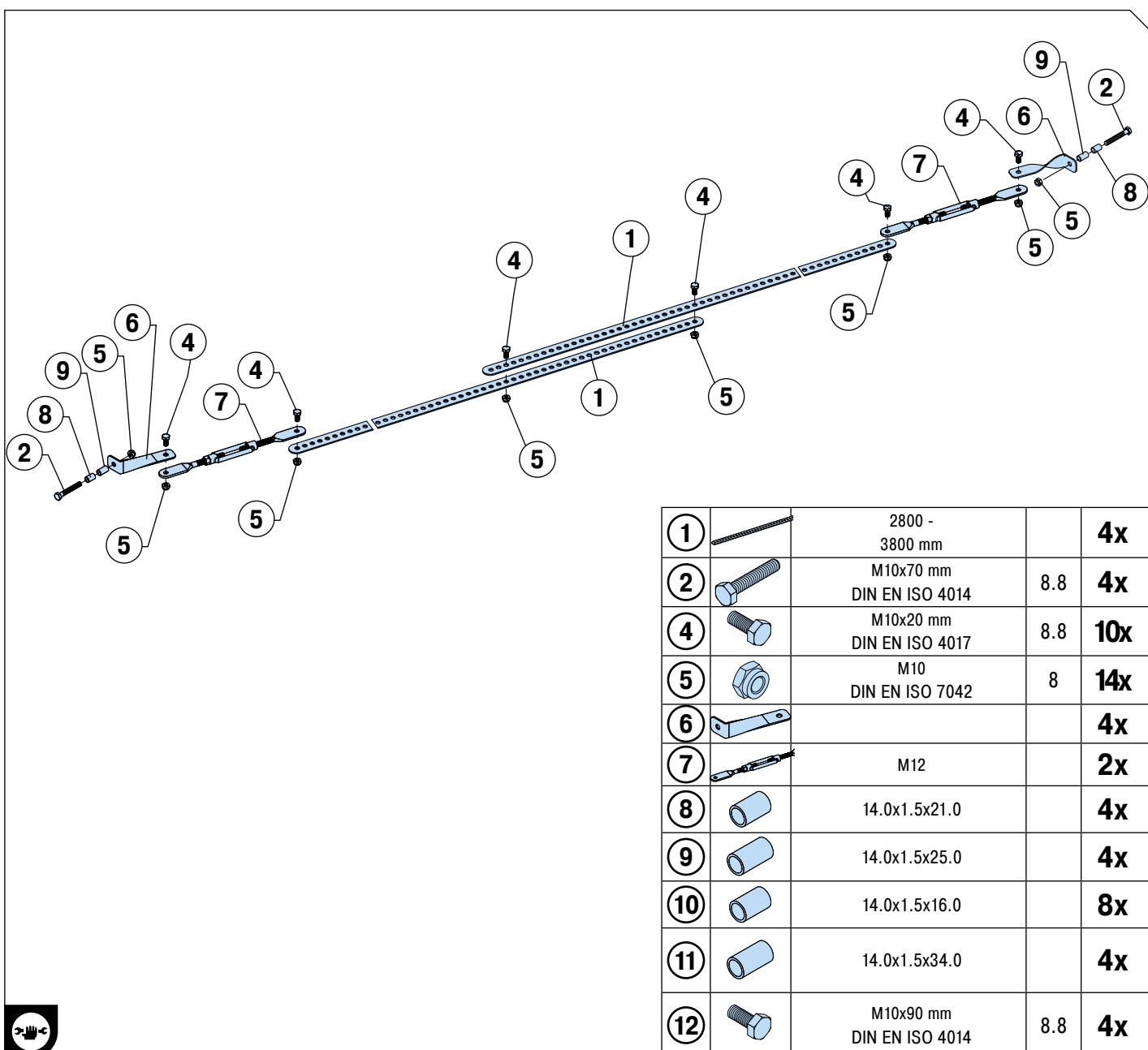
4. | Ausrichtungshilfe für leichtere Montage eines Palettenregals
