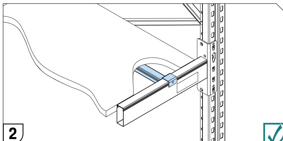
4. | Spanplattenböden auf Stufentraversen
